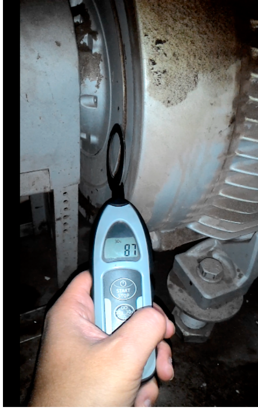
Resim 9: 32 Hz'de çalışan motordaki mil akımı atlama sayılarının ölçümü
