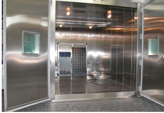
Şekil 3. Fotovoltaik modül test odası [4]
