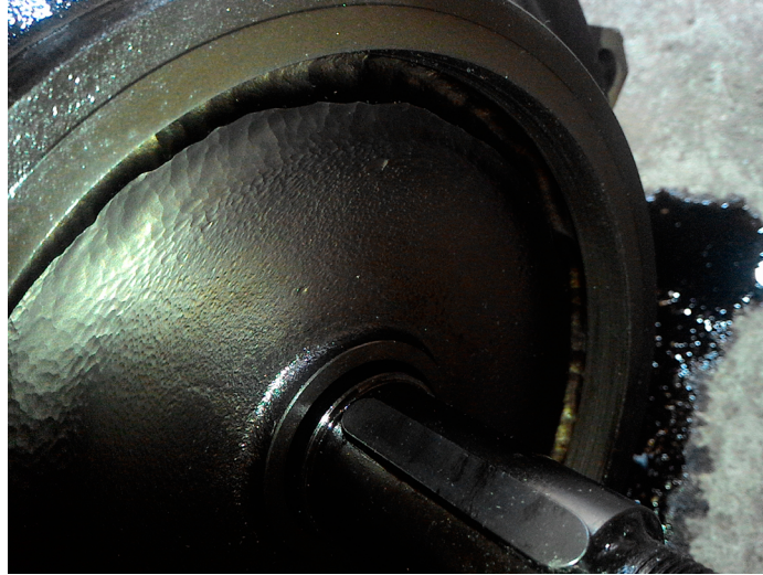
Resim 4: Pompanın 32 Hz'deki çalışması sonucu oluşan vorteksin verdiği hasar
