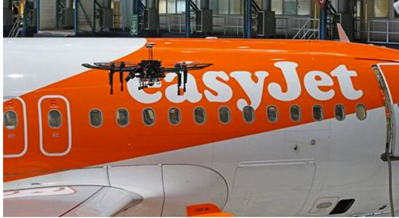
Şekil 1. Modifiye edilmiş bir DJI Matrice İHA ile easyJet Airbus A319 incelenirken [4].
