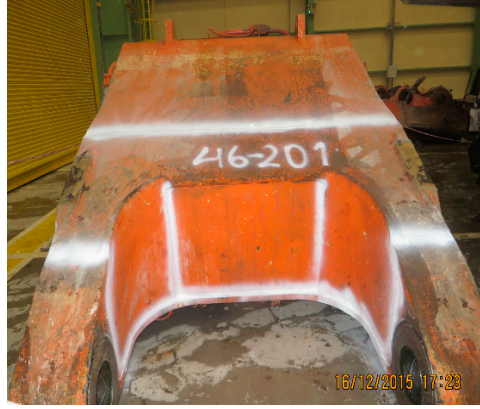
Resim 4. Revizyona giren bir makinenin VT, MT ve UT kontrolünün yapılması
