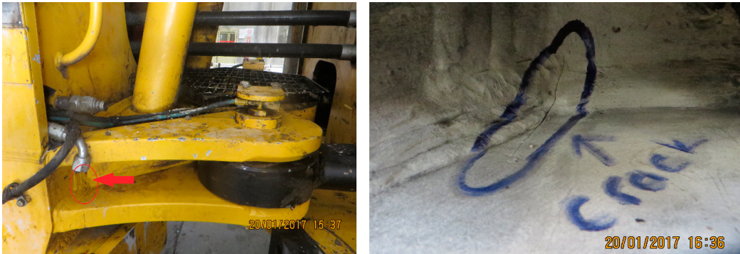
Resim 3. Bakıma gelen bir makinenin VT kontrolü sonucu çatlak şüphesiyle MT kontrolü yapılması sonucu ortaya çıkan çatlak ve çatlağın durumu.
