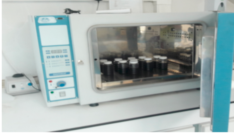
Resim 7. Yağ numunesi alınan yağların viskozite testinin yapılması
