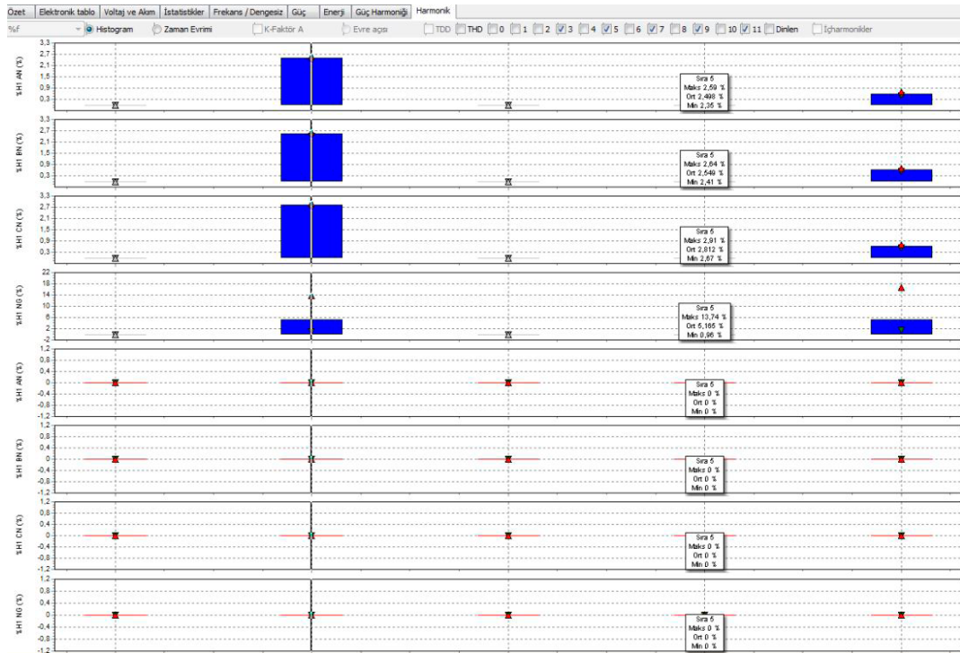
Resim 8: 32Hz'de çalışan motorun 3,5,7,9 ve 11. Harmonikleri
