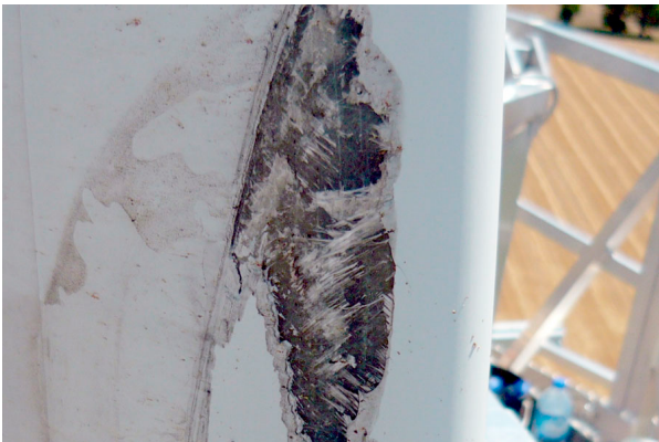
Şekil 5. Rüzgar türbin kanatlarında meydana gelen arızalar ve bakımları (BR, 2019; BS, 2019; FT, 2019)
