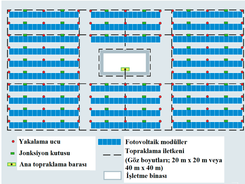
Şekil 7. Saha montajlı fotovoltaik santrallerde topraklama ve yıldırıma karşı koruma sistemi [3]
