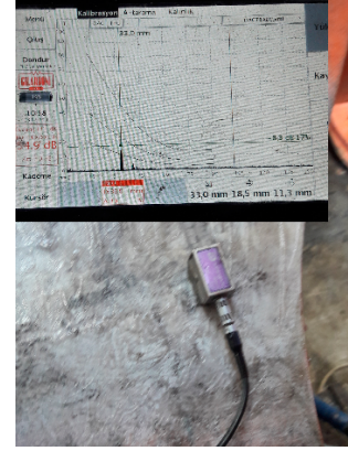
Resim 4. Revizyona giren bir makinenin VT, MT ve UT kontrolünün yapılması
