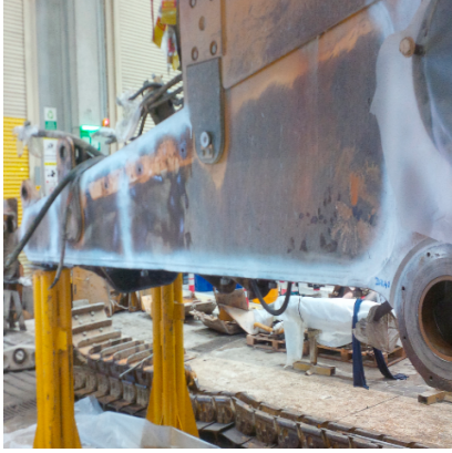
Resim 4. Revizyona giren bir makinenin VT, MT ve UT kontrolünün yapılması
