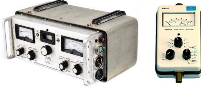
Şekil:3 1980'lerde kullanılan Analog Vibrasyon Ölçüm ve Analiz Cihaz Örnekleri
