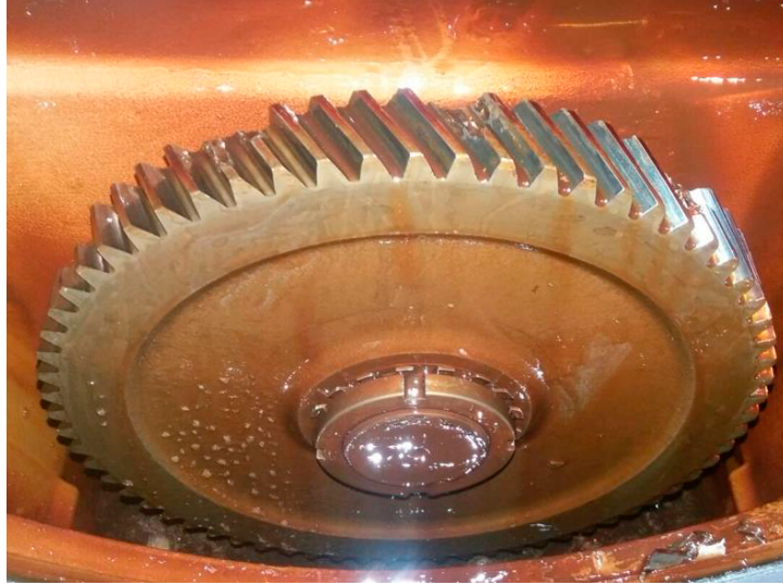
Şekil 2.8 2. Dişlideki kırık durumunun görünümü
