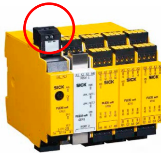
Soketin PLC Üzerinde Görünüşü
