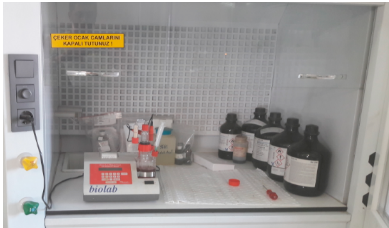
Resim 4. Yağ numunesi alınan yağların içindeki suyun tespitinin yapılması
