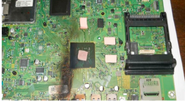
Şekil 4.1 İnverter Kart Yanması
