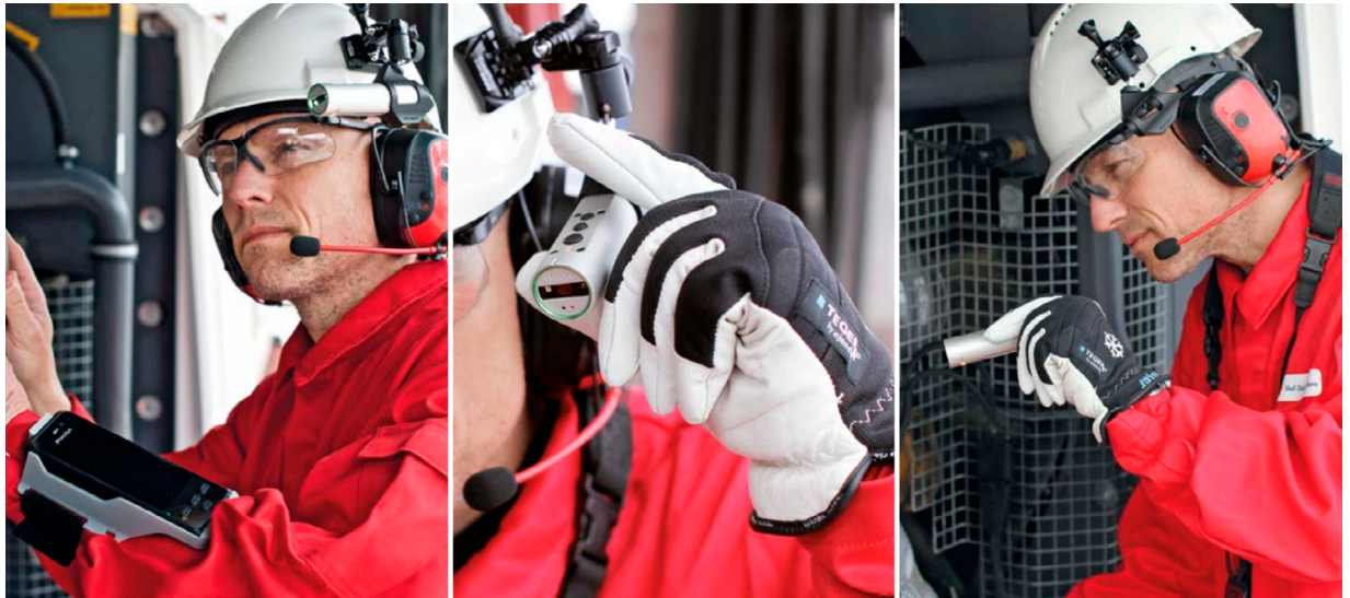
Şekil 14 : WiFi ATEX Kaska Takılabilir Endüstriyel Kamera ve haberleşme düzeneği [4]
