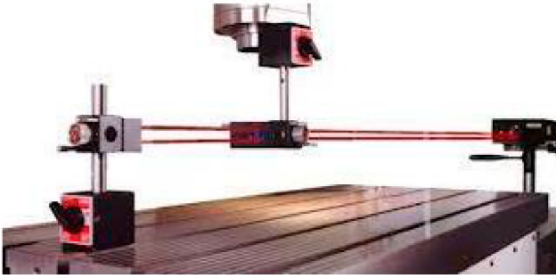
Şekil 7. Makine tablasına bağlanmış lazer interferometre
