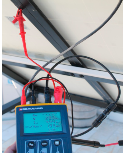
Şekil 5. Seaward solar test cihazı ölçüm işlemi için prob bağlantılarının yapılması [5]
