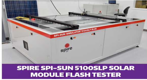
Şekil 2. Fotovoltaik modüller için güneş simülatorü [3]
