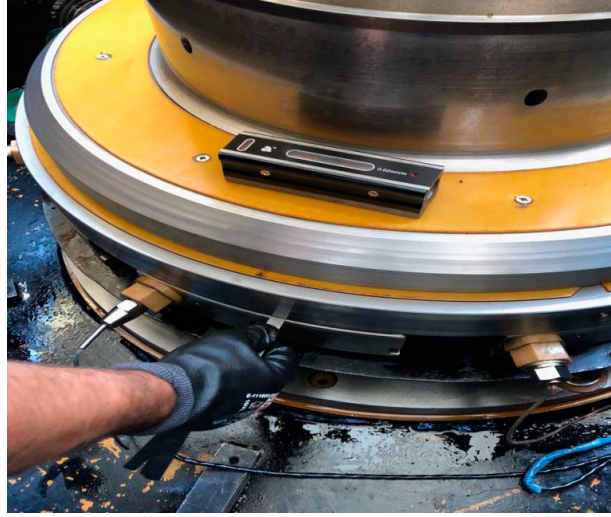
Şekil 3.4 Taşıyıcı yatak ölçümleri ve ayarı
