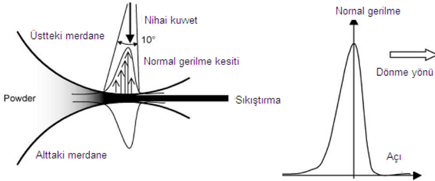
Şekil 4. Basınçsal elektrikli dönüştürücü tarafından ölçülen gerilme kesiti.
