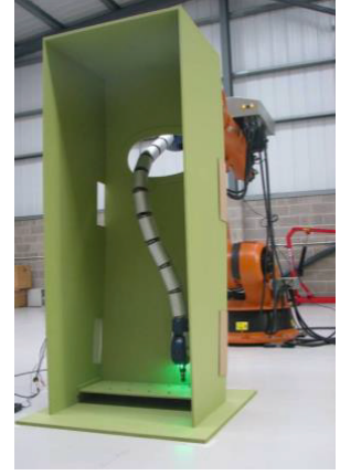
(a) Taşınabilen robotik kol [3], (b) Son eyleyicisine yılan benzeri kol ilave edilmiş endüstriyel robot [2]
