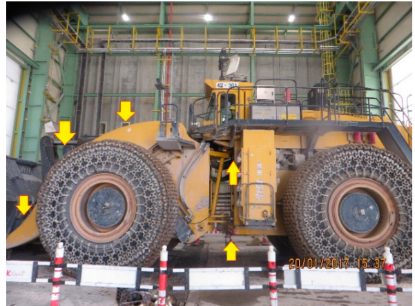
Resim 1. Sahada ve atölyede VT Kontrolü yapılan bir İş makineleri
