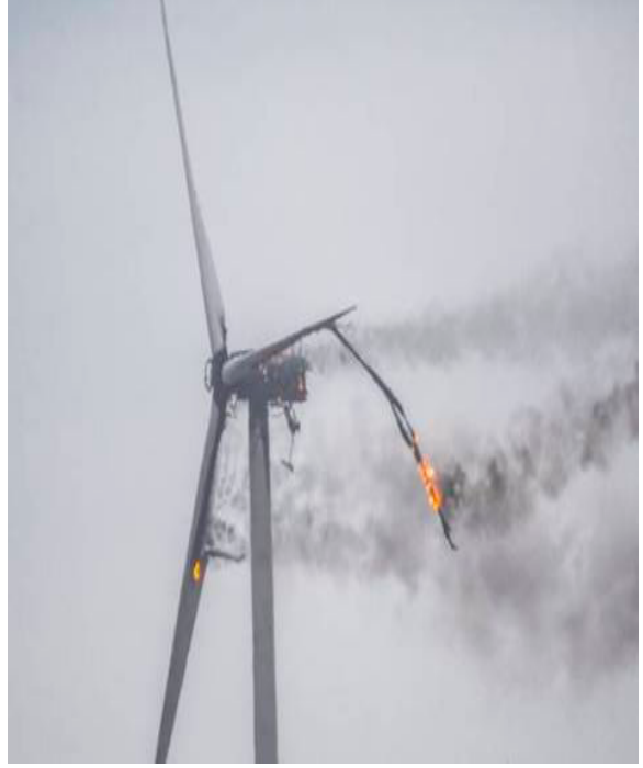
Şekil 4. Rüzgar türbini kanatlarında meydana gelen büyük hasarlar (Shreve, 2018; NWW, 2016; NNYW, 2018;
