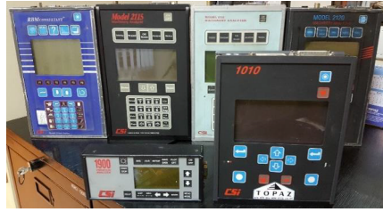
Şekil 5: 1990'lar ile hızlı gelişim gösteren Dijital Vibrasyon Ölçü Analiz Cihazları
