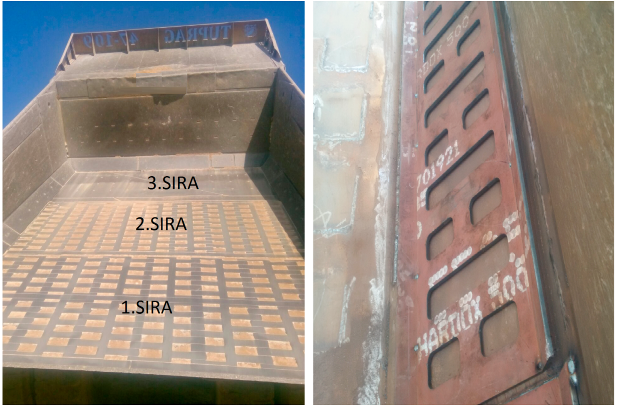
Resim 10. Cat 785C Kaya kamyonu Modifikasyonlu Damper Aşını plakaları dizilimi
