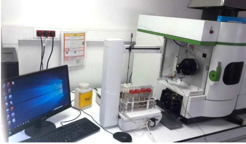
Resim 5. Yağ numunesi alınan yağların elementer analizinin yapılması
