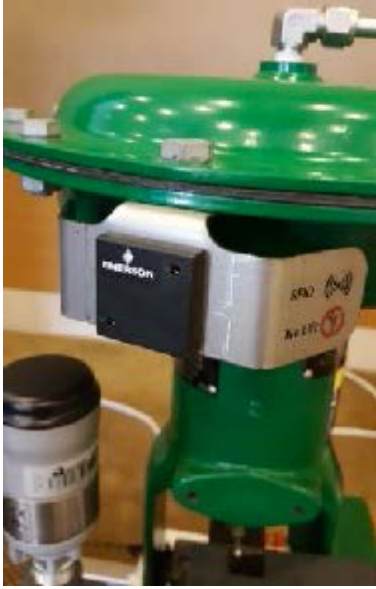
Şekil 15: RFID takılı Vana ve RFID okuyucu örneği [4]
