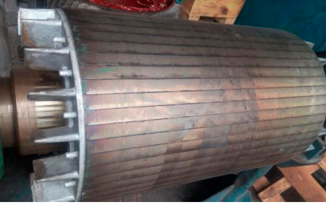
Şekil 13: VE-4 MEXA191 ekipmanına ait arızalı rotor
